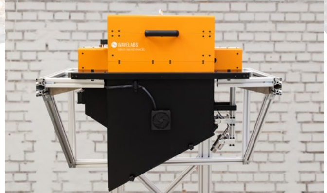
Der SINUS-360 ADVANCED kommt z. B. bei Effizienzmessungen von Solarzellen und Experimenten in der Materialwissenschaft zum Einsatz.
