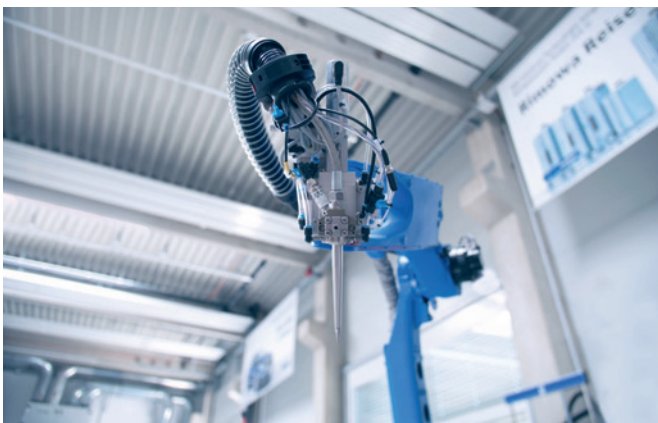
Das Dosierventil der einkomponentigen Schaumdichtungstechnik von CeraCon ist so schlank, dass es von einem einfachen 6-Achs-Industrieroboter gehandelt werden kann.
