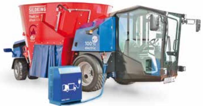
Der SILOKING TruckLine 4.0 eTruck ist ein 100 % elektrisch angetriebener selbstfahrender Futtermischwagen.
