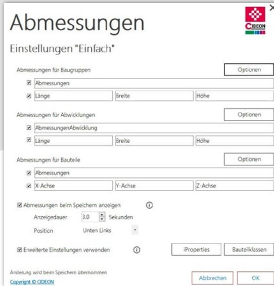
Konfiguration der Abmessungen im Modus „Einfach“
